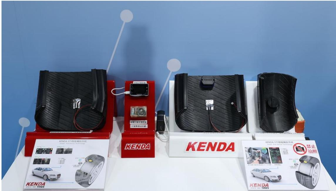
除了基本的胎壓與胎溫，智能輪胎監控系統並提供輪胎的里程資訊，可即時掌握輪胎磨耗狀態。
